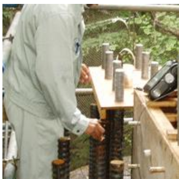
埋め込みアンカーボルト 長さ測定風景
