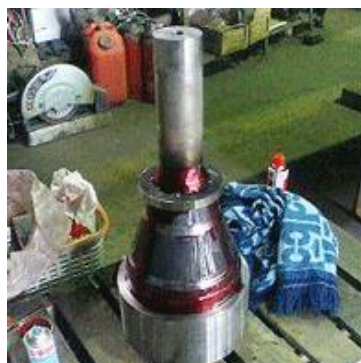
浸透探傷検査風景
